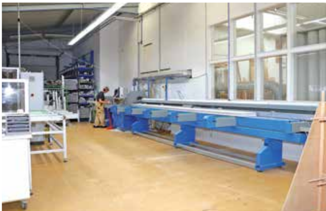
Die Zuschnittsäge für die Profile soll noch einen anderen Platz in der Werkstatt bekommen, um den Laufweg des Mitarbeiters zum Verschweißen zu verkürzen und damit den Durchlauf zu erhöhen.
